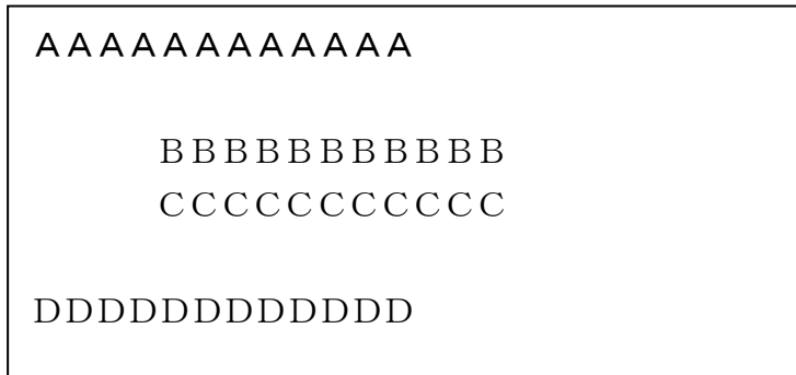
図 3-3 <blockquote> タグによる段落効果：BとCによる文とその前後の空白行
